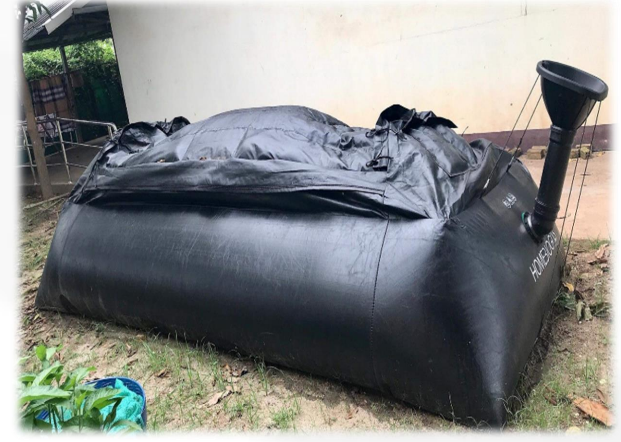
Ev Tipi Biyogaz Sistemi
